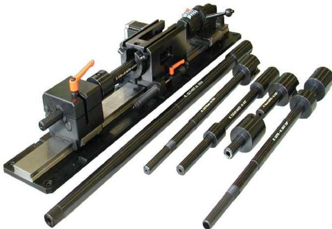
Рисунок 2 - Баллистический затвор UZ-2002 и измерительные баллистические стволы
