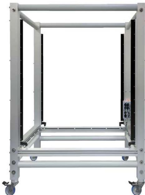
Рисунок 4 - WLS03 - стандартная передвижная атмосферостойкая оптическая рамка
