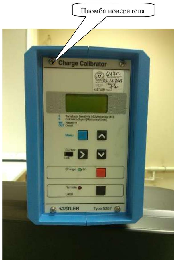
Рисунок 6 - Kistler 5357B10 - калибратор заряда для баллистического анализатора ВА04S
