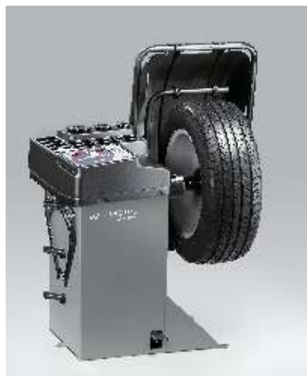
Рисунок 1 - Общий вид стенов балансировочных VAS 6348
