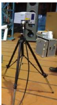
Рисунок 3 - Двухмерный лазерный сканирующий виброметр PSV-500-H
