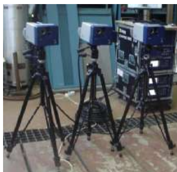
Рисунок 4 - Трехмерный лазерный сканирующий виброметр PSV-400-3D в рабочем положении
