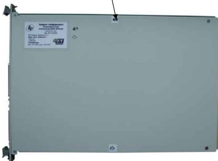
Рисунок 2 - Схема пломбировки функциональных модулей
