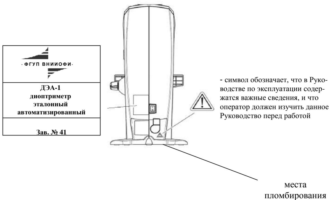
Рисунок 2 - Схема маркировки (вид сзади) и места пломбирования
