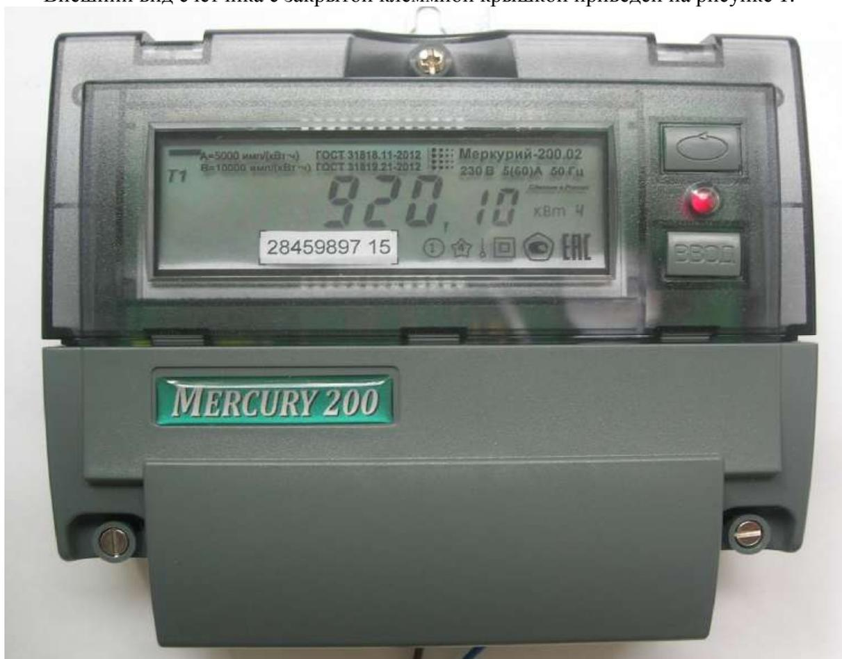
Рисунок 1 - Внешний вид счетчика с закрытой клеммной крышкой
