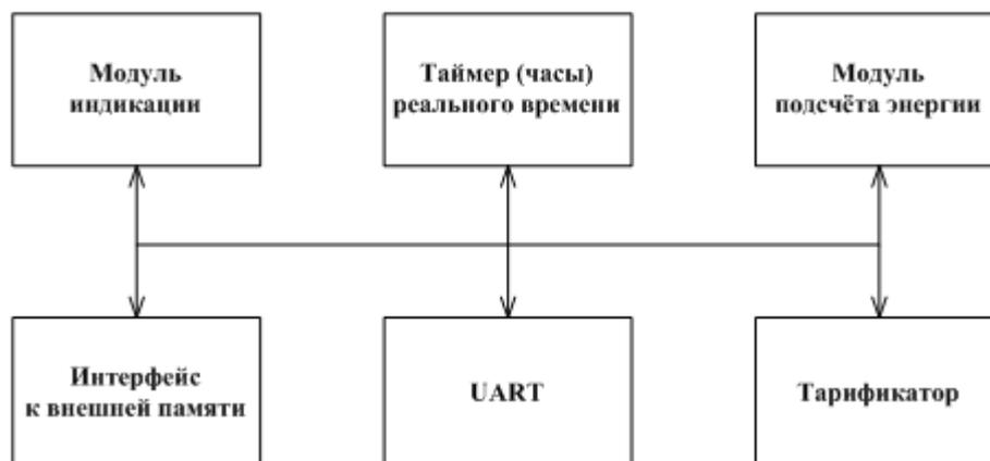
Рисунок 3 - Структура программного обеспечения «Меркурий 200»
