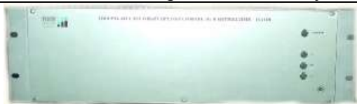
Рисунок 7 - Электронный блок ЦАП Н для вывода пропорционального аналогового сигнала 100/\sqrt{3} В ДНЕЭ
