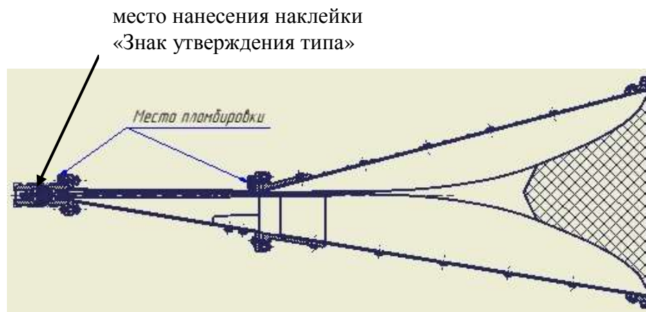
Рисунок 2 - места нанесения знака утверждения типа и защиты от несанкционированного доступа в виде пломбировки корпуса
