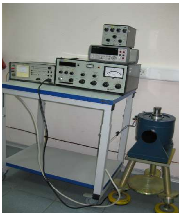
Рисунок 1 - Внешний вид виброустановки
