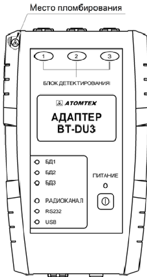
Рисунок 3 - Схема с указанием места пломбирования адаптера BT-DU3
