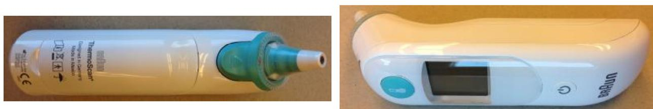
Рисунок 1 - Термометры электронные ушные Braun ThermoScan 7, тип IRT6020.
