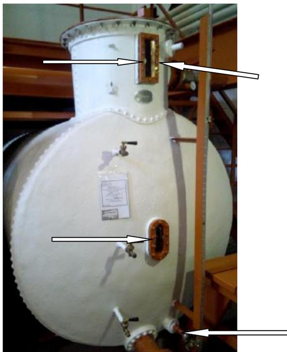
Рисунок 1 - Общий вид и схема пломбировки мерника
