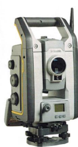
Рисунок 3 - Общий вид тахеометров электронных Trimble S7
