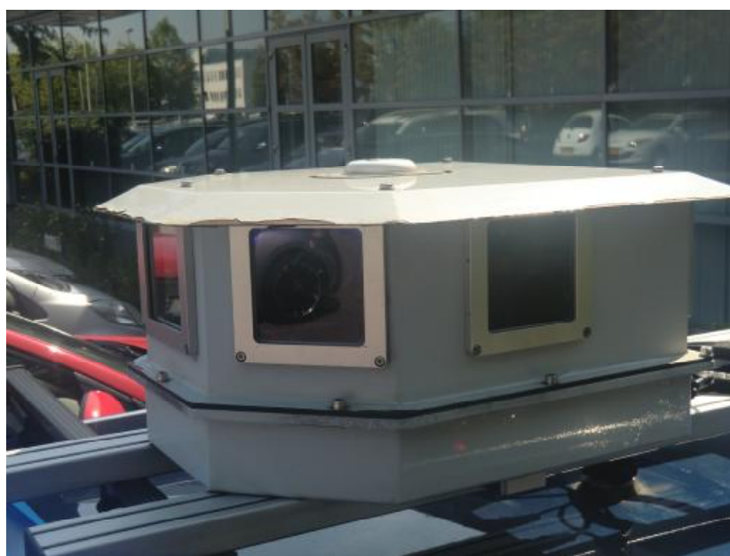
Рисунок 1 - Блок первичных датчиков, установленный на крыше автомобиля
