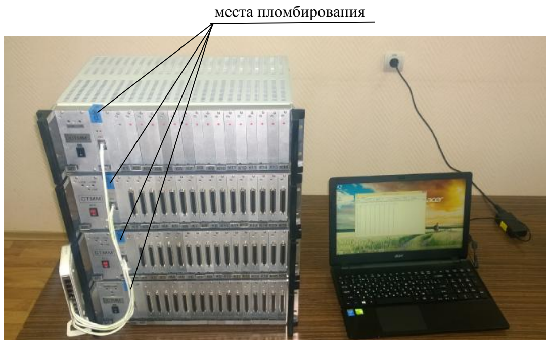
Рисунок 1- Общий вид системы измерительной СТММ и схема пломбировки от несанкционированного доступа
