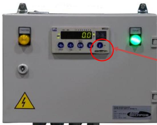
Рисунок 6 - Место пломбирования прибора WE2111, встроенного в ШИ (наносится разрушаемая наклейка справа от вспомогательной клавиатуры)
