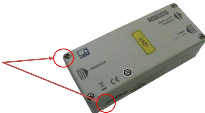
Рисунок 8 - Место пломбирования корпуса устройства обработки аналоговых данных AED9101 (пломбы устанавливаются на передней панели корпуса AED, встроенного в ШИ)
