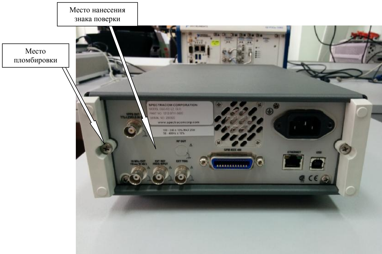
Рисунок 2 - Внешний вид имитатора (задняя панель)
