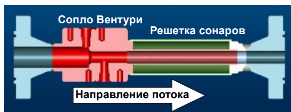
Рисунок 4. Катушка многофазного расходомера в исполнении «VS».
