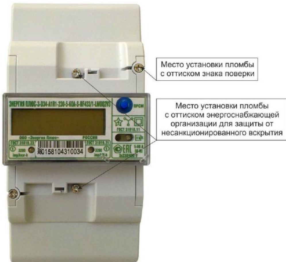
Рисунок 6 – Общий вид счетчика в корпусе типа D34
