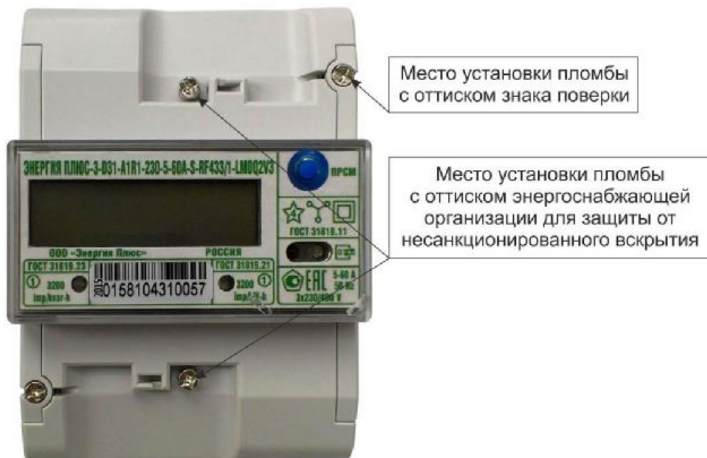
Рисунок 4 – Общий вид счетчика в корпусе типа D31
