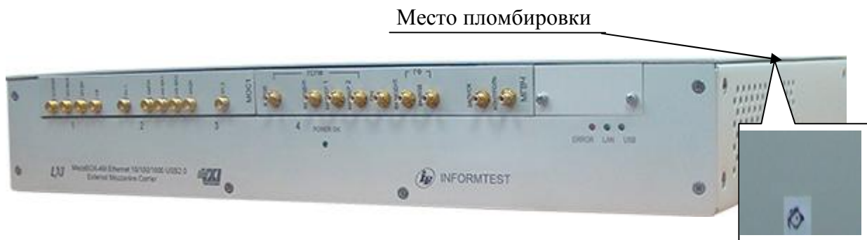
Рисунок 2 – Схема пломбировки LXI-крейта MezaBOX-4M LXI
