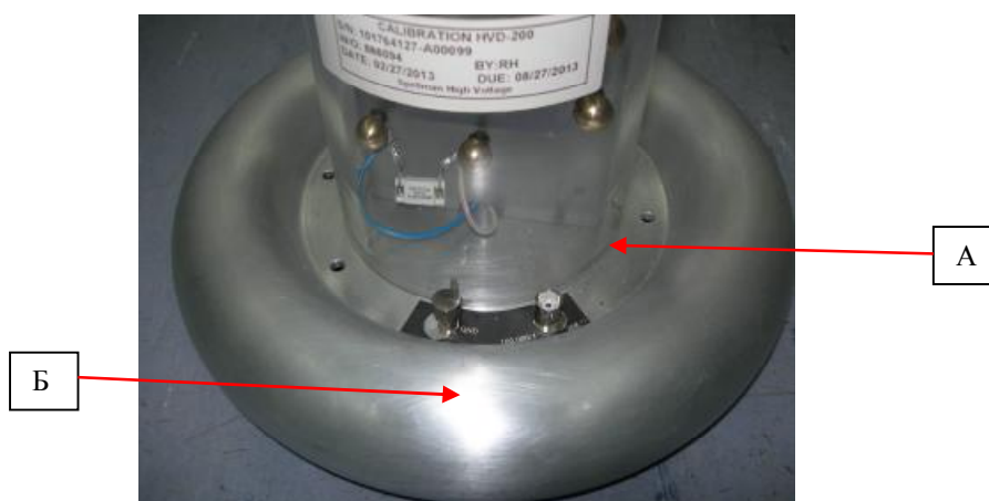
Рисунок 2 - Место пломбировки от несанкционированного доступа (А) и нанесения знака поверки (Б)
