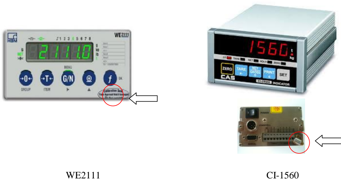
Рисунок 2 - Общий вид приборов и схемы их пломбирования
