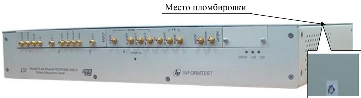
Рисунок 2 – Схема пломбировки LXI-крейта MezaBOX-4M LXI
