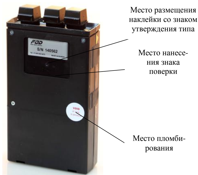
Рисунок 2 - Место пломбирования от несанкционированного доступа
