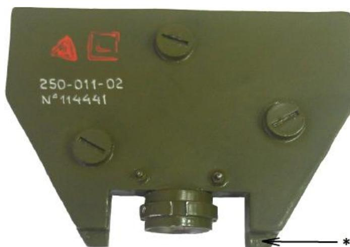
Рисунок 3 - Внешний вид измерительного зонда. \* - место пломбировки
