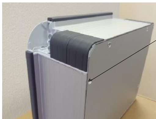
Рисунок 3- Корпус блока ввода-вывода Flowvision. Место пломбирования
