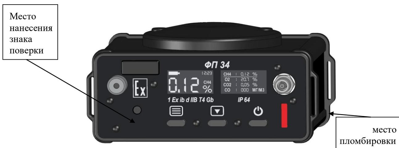
Рисунок 1а. Внешний вид газоанализатора ФП34 с модулем привязки к местности
