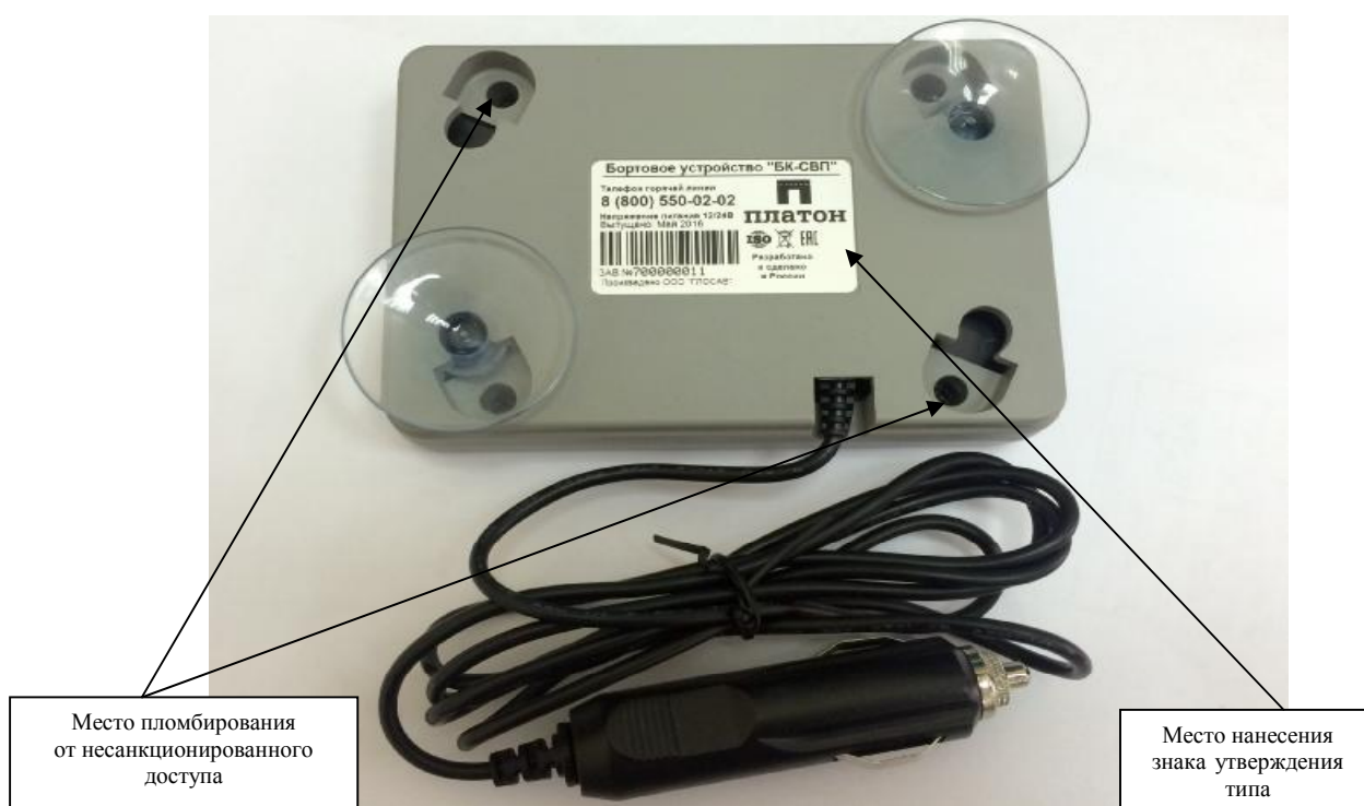
Рисунок 2 – Место нанесения знака утверждения и пломбировки от несанкционированного доступа
