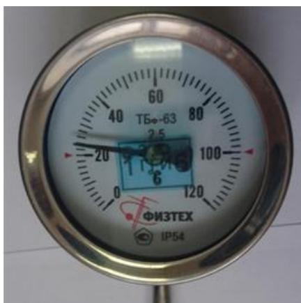
Рисунок 5 – Место нанесения знака поверки на стекло
