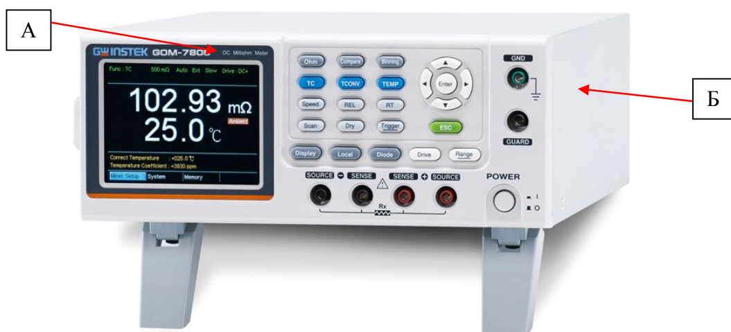
Рисунок 1 – Внешний вид миллиомметров и места нанесения знака утверждения типа (А) и знака поверки (Б)
