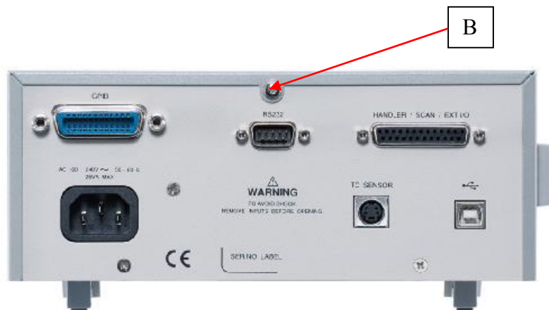
Рисунок 2 – Место опломбирования от несанкционированного доступа (B)
