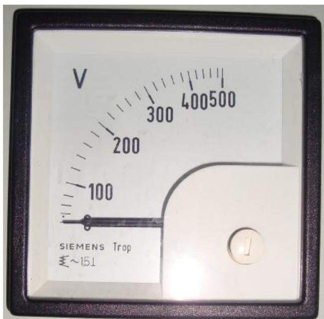
Рисунок 1 – Вольтметр щитовой SQ 72 DE
