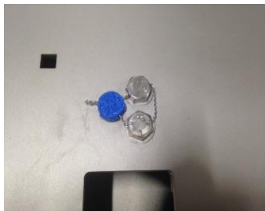
Пломбировка весоизмерительного датчика
