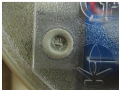
Рисунок 4 – Место пломбирования ОТК
