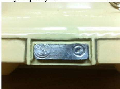
Рисунок 3 – Место пломбирования и нанесения знака поверки
