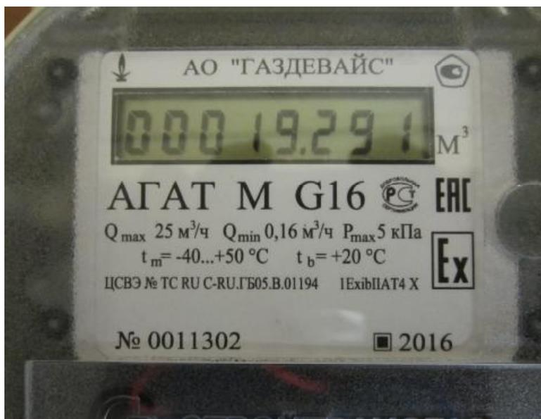
Рисунок 2 – Маркировочная табличка счетчика газа
