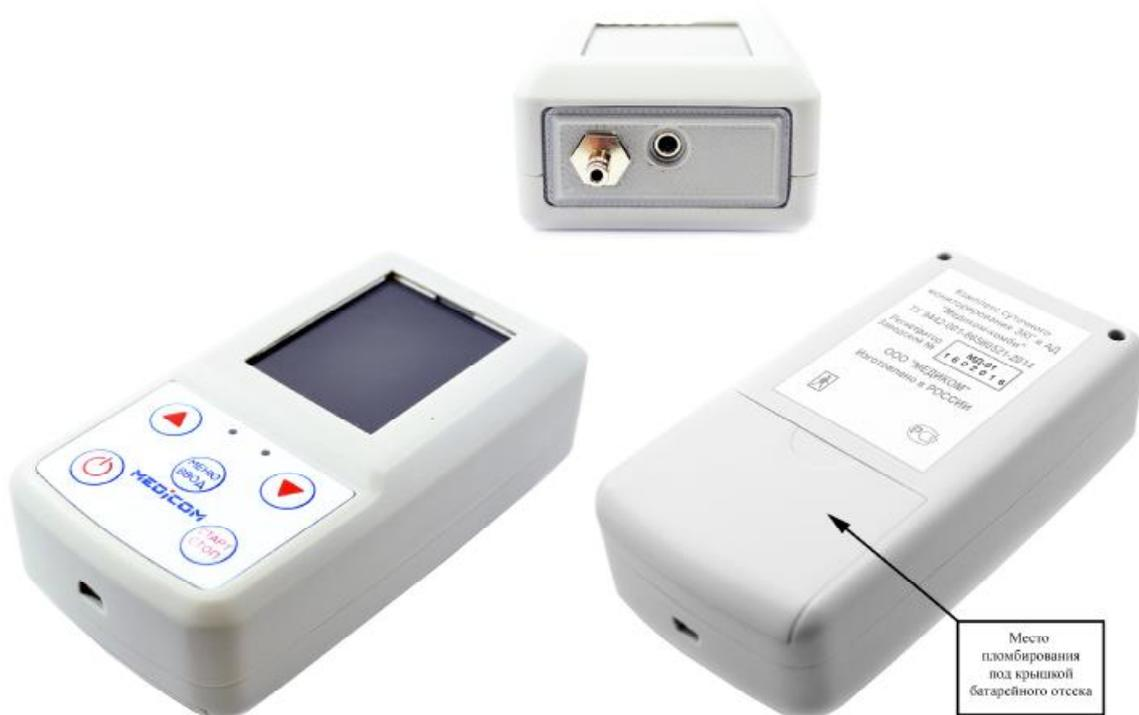
Рисунок 2 – Общий вид комплекса с регистраторами МД-01 и МД-01М с указанием места пломбировки от несанкционированного доступа
