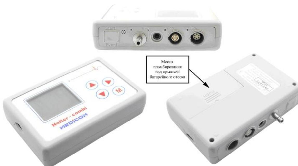
Рисунок 5 – Общий вид комплекса с регистратором КР-05 с указанием места пломбировки от несанкционированного доступа
