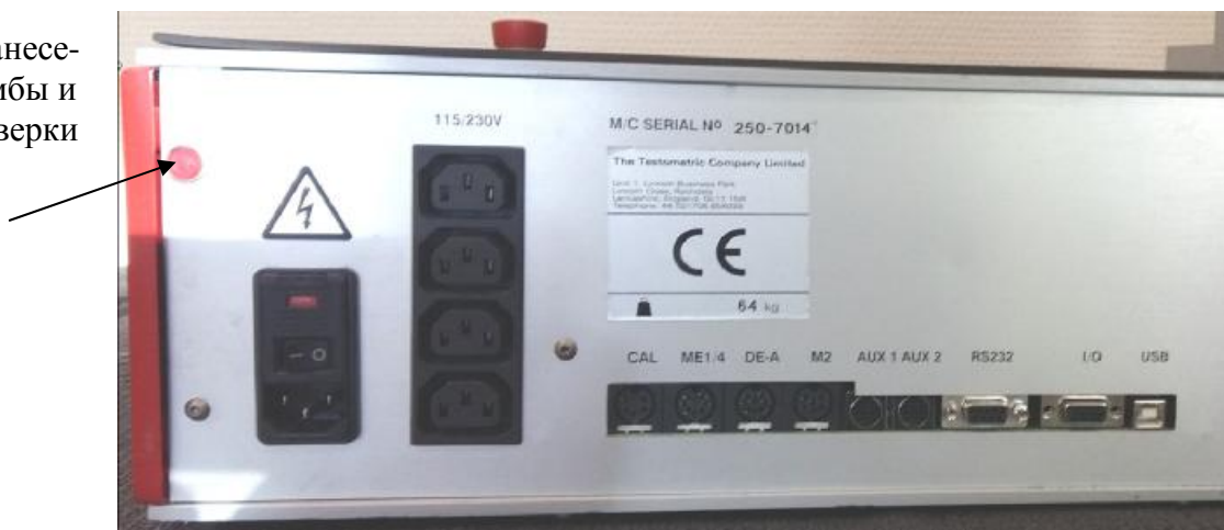
Рисунок 3 – Схема пломбирования от несанкционированного доступа
