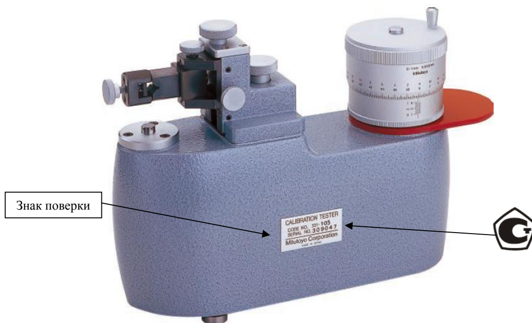
Рисунок 3 – Общий вид приборов серии 521 для поверки измерительных головок и датчиков и места нанесения знаков утверждения типа и поверки
