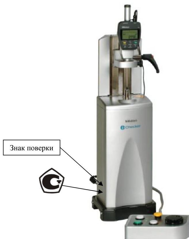
Рисунок 2 – Общий вид приборов серии 170 для поверки измерительных головок и датчиков автоматического типа (I-Checker) и места нанесения знаков утверждения типа и поверки
