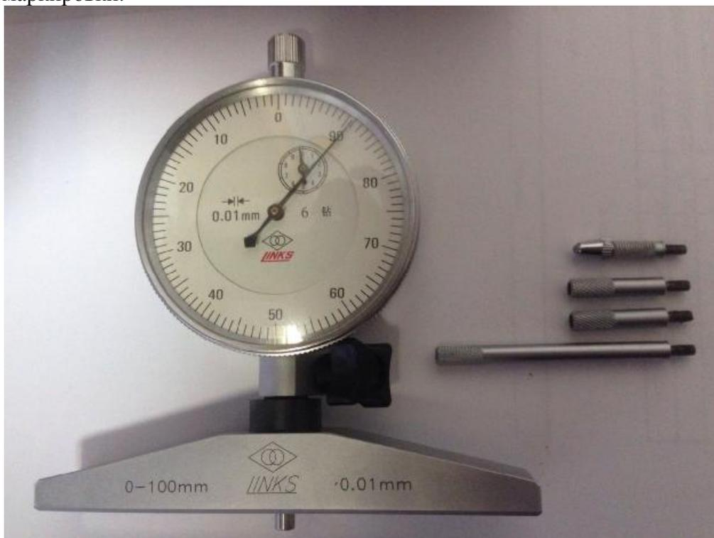
Рисунок 1 – Общий вид глубиномеров индикаторных серии 819
