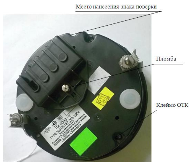
Рисунок 1 – Внешний вид приборов ПА8090, ПА8090-2, ПА8090-4, пломбировка и место нанесения знака поверки в виде клейма
