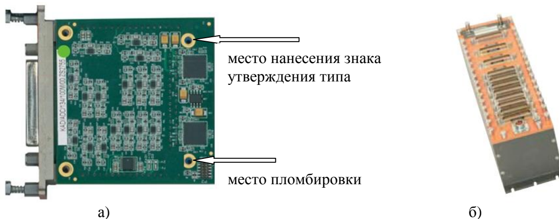
Рисунок 1 - Общий вид модуля (а) и модуля, установленного в блок базовый КАМ/СНС/13U (б)
