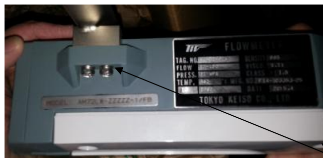
Рисунок 2 - Обозначение места пломбировки ротаметров AM91LW
