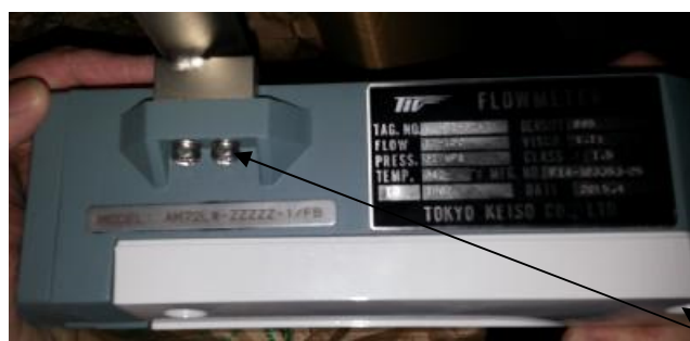
Рисунок 2 - Обозначение места пломбировки ротаметров М-901
