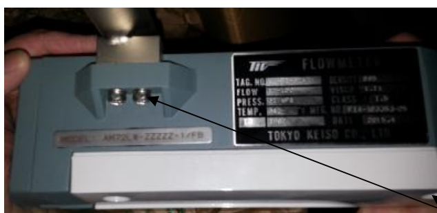
Рисунок 2 - Обозначение места пломбировки ротаметров М-901
