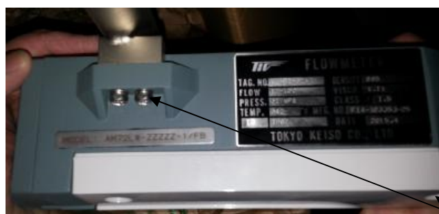
Рисунок 2 - Обозначение места пломбировки ротаметров М-901
