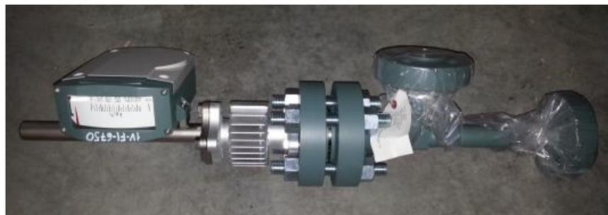
Рисунок 1 - Общий вид ротаметров AM72LW
