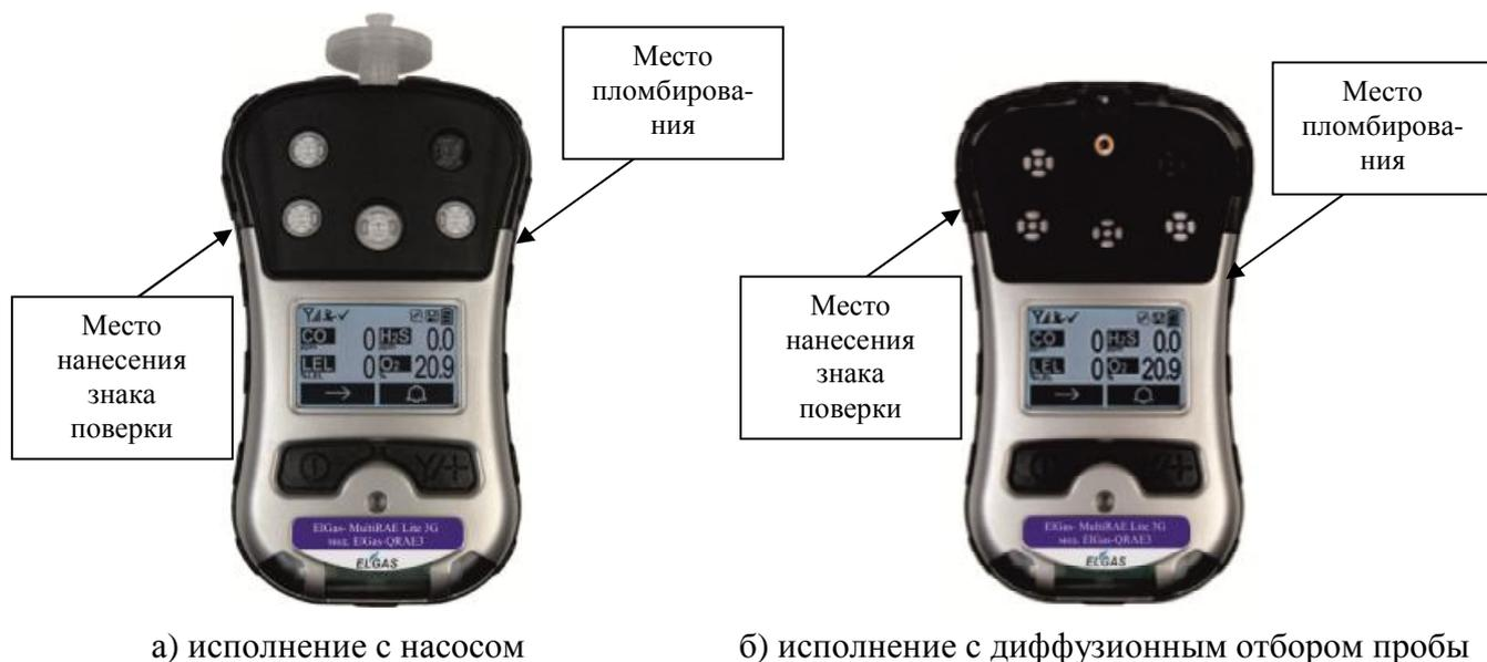
Рисунок 2 – Фото общего вида газоанализатора EIgas мод. EIgas-MultiRAE Lite 3G EIgas-QRAE 3 с указанием места пломбирования и нанесения знака поверки
