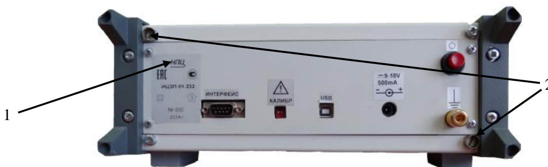
1- место нанесения знака утверждения типа 2 - места пломбировки от несанкционированного доступа Рисунок 2 - Внешний вид измерителя (вид сзади)
