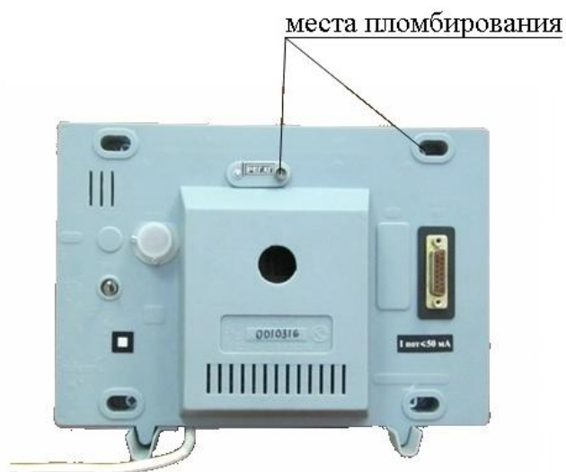
Рисунок 2 - Схема пломбирования от несанкционированного доступа
