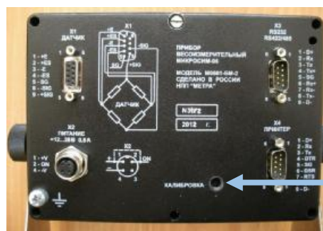
Рисунок 2 - Места пломбирования терминала M0601 для нанесения знака поверки
