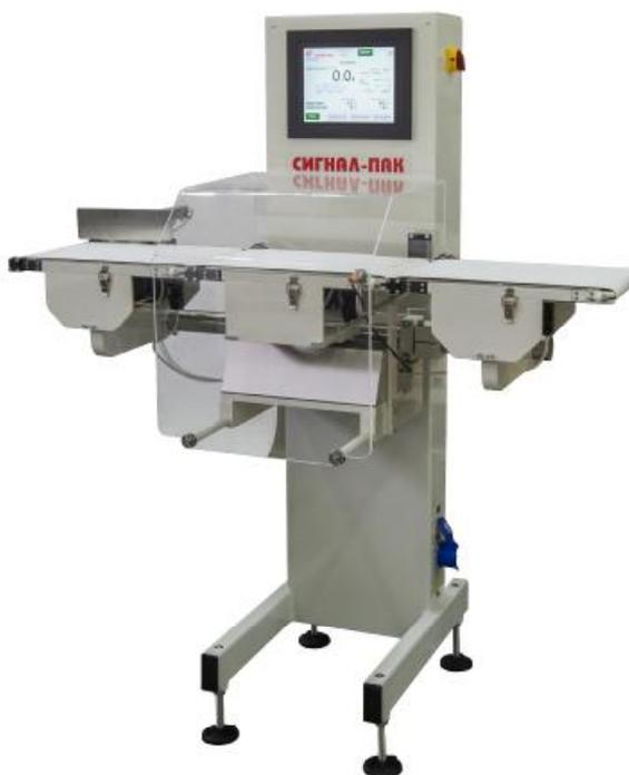
Рисунок 1 - Фотография внешнего вида устройств контроля веса УКВ
