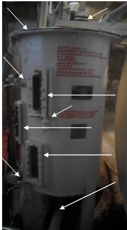
Рисунок 1 - Общий вид и места пломбирования мерника
